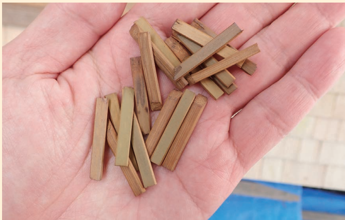
『こけら板』を止める釘には伝統的な竹釘を使用（今回はステンレス釘も併用）。竹を細く割り、煎って硬くしたもの。
